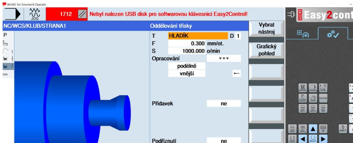
Obr. 12 Grafické znázornenie v programe Sinumerik Operate (rezné podmienky - hladenie)
