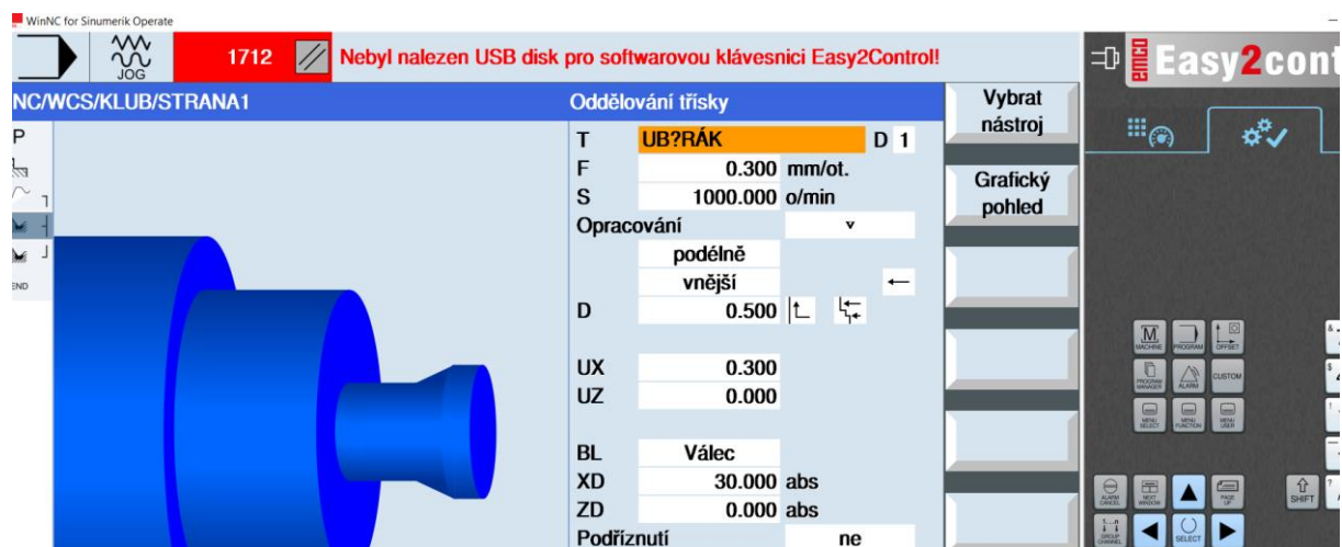
Obr. 10 Grafické znázornenie v programe Sinumerik Operate (rezné podmienky - hrubovanie)
